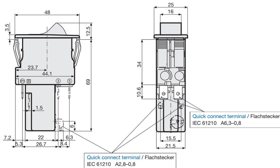
**Mechanical lock-out latch / Mechanische Schaltsperre**
