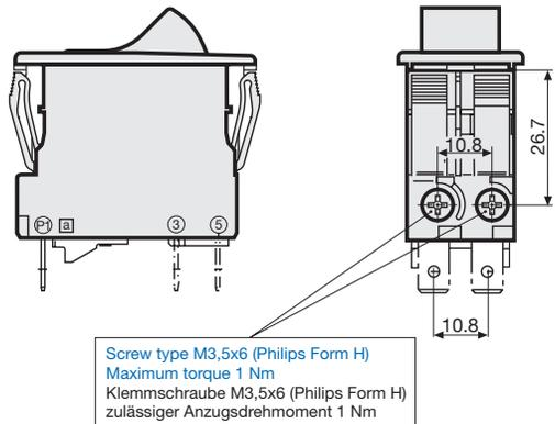
**Cut-out and pin-out / Montageöffnung und Anschlussbelegung**
