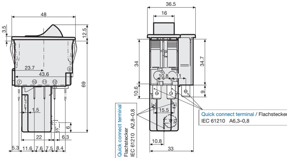
**Mechanical lock-out latch / Mechanische Schaltsperre**
