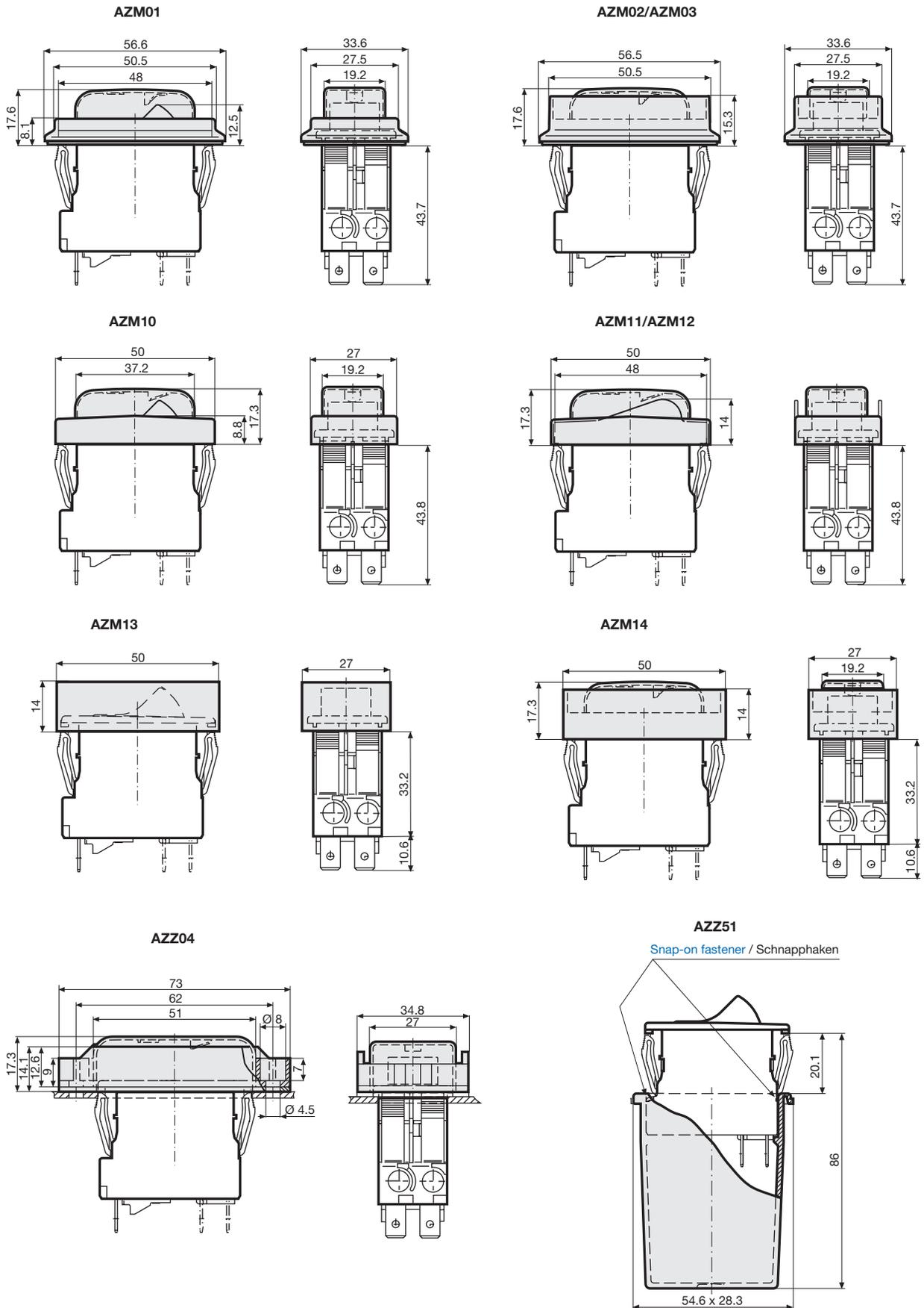
**Quick connect terminals / Flachsteckeranschlüsse**
