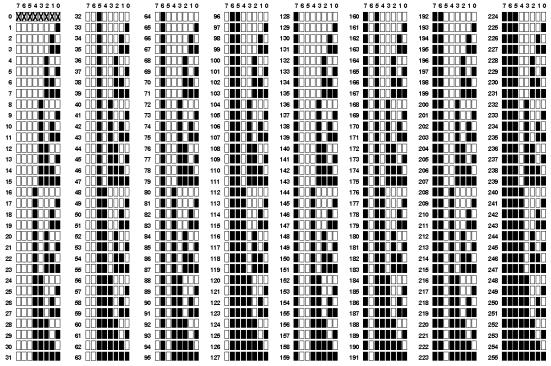
■ = JUMPER INSTALLED □ = NO JUMPER
