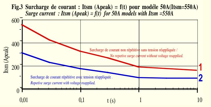
1 - **Itsm non répétitif** sans tension réappliquée est donné pour la détermination des protections.
