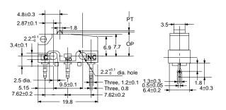
Hinge Lever SSG-01L1P SSG-5L1P SSG-01L1P-5 SSG-5L1P-5
