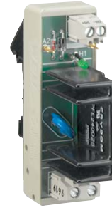
24 V DC / 250 V AC / 6 A 2 wire output
