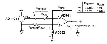
Figure 17. Celsius or Fahrenheit Thermometer
