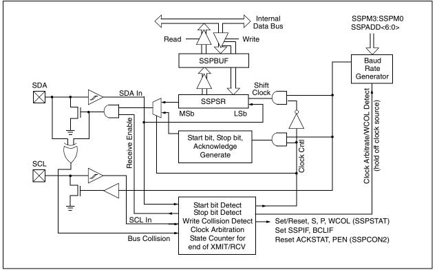
MSSP BLOCK DIAGRAM (I<sup>2</sup>C<sup>™</sup> MASTER MODE)
