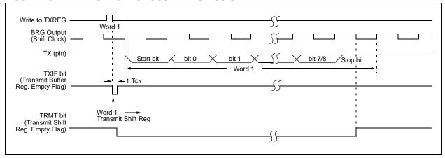
FIGURE 16-5: ASYNCHRONOUS TRANSMISSION (BACK TO BACK)
