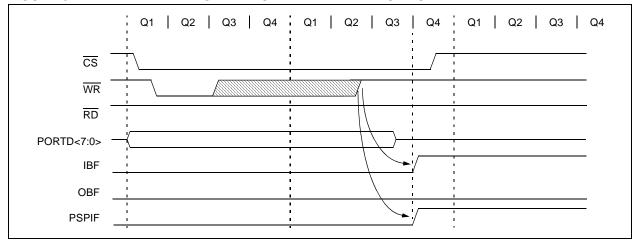
FIGURE 9-5: PARALLEL SLAVE PORT READ WAVEFORMS
