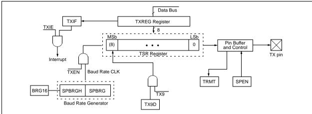
FIGURE 16-4: ASYNCHRONOUS TRANSMISSION
