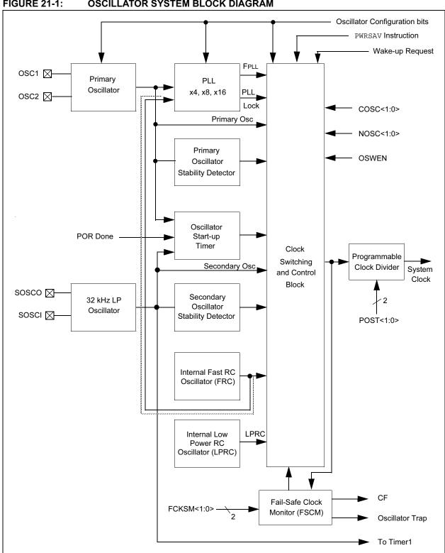
**FIGURE 21-1: OSCILLATOR SYSTEM BLOCK DIAGRAM**
