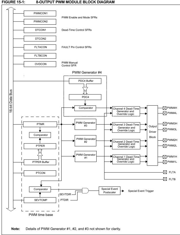
8-OUTPUT PWM MODULE BLOCK DIAGRAM
