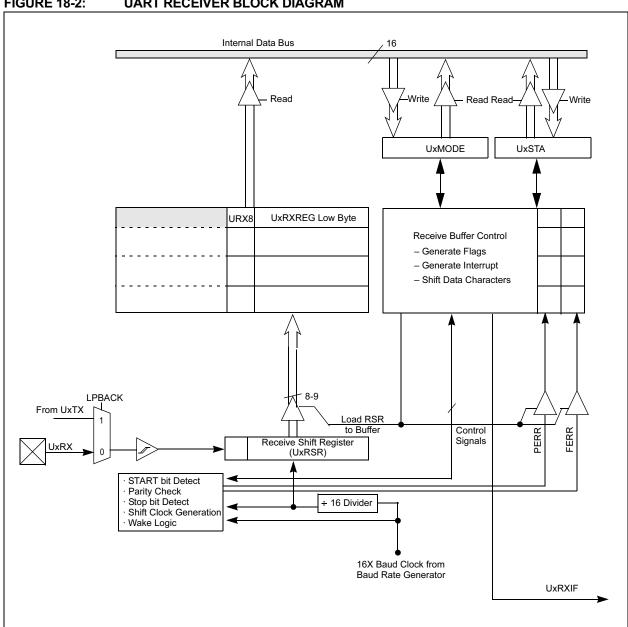
**FIGURE 18-2: UART RECEIVER BLOCK DIAGRAM**
