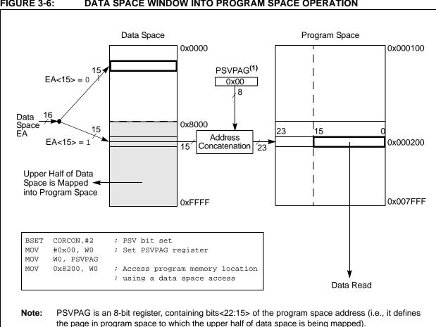
FIGURE 3-6: DATA SPACE WINDOW INTO PROGRAM SPACE OPERATION
