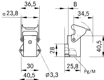
**EPIC® H-A 3 Gehäuse: Sockelgehäuse mit offenem Boden**
