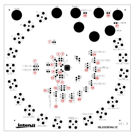
FIGURE 3. JUMPER LOCATOR DIAGRAM
