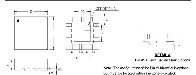
**Dimensions In Millimeters Dimensions In Inches** Symbol Min Max Min Max 0.700 0.800 0.028 0.031 Α **A1** 0.000 0.050 0.000 0.002 0.250 A3 0.175 0.007 0.010 b 0.180 0.300 0.007 0.012 D 2.950 3.050 0.116 0.120 D2 1.300 1.750 0.051 0.069 Ε 2.950 3.050 0.116 0.120 E2 1.300 1.750 0.051 0.069 0.500 0.020 е
