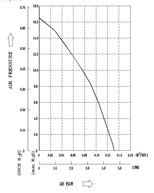
\* TEST CONDITION: INPUT VOLTAGE ------ OPERATION VOLTAGE TEMPERATURE ------ ROOM TEMPERATURE HUMIDITY ------ 65%RH
