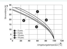
Abbildung zeigt die Deratingkurve der Klemme ST 4... in Verbindung mit dem Stecker SP 4  $\,$
