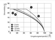
Abbildung zeigt die Deratingkurve der Klemme ST 2,5... in Verbindung mit dem Stecker SP 2,5
