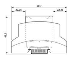
Maßzeichnung zeigt den Artikel mit Gehäuseoberteill (Klemmeneinbautiefe 22,35 mm) und Gehäusedeckel
