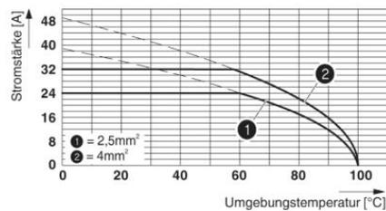
Derating-Diagramm für 5 Pole; Reduktionsfaktor=1
