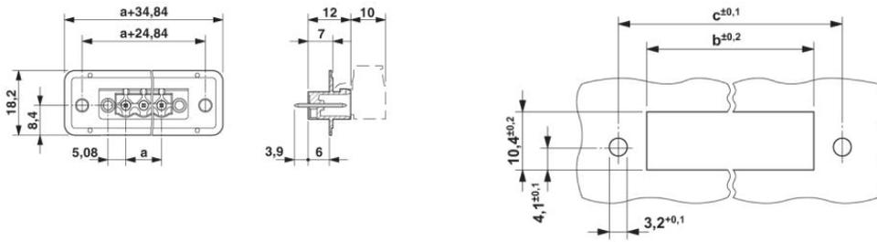
Maß b =  $10,49\text{mm} + (\text{Polzahl} \times 5,08\text{mm})$
