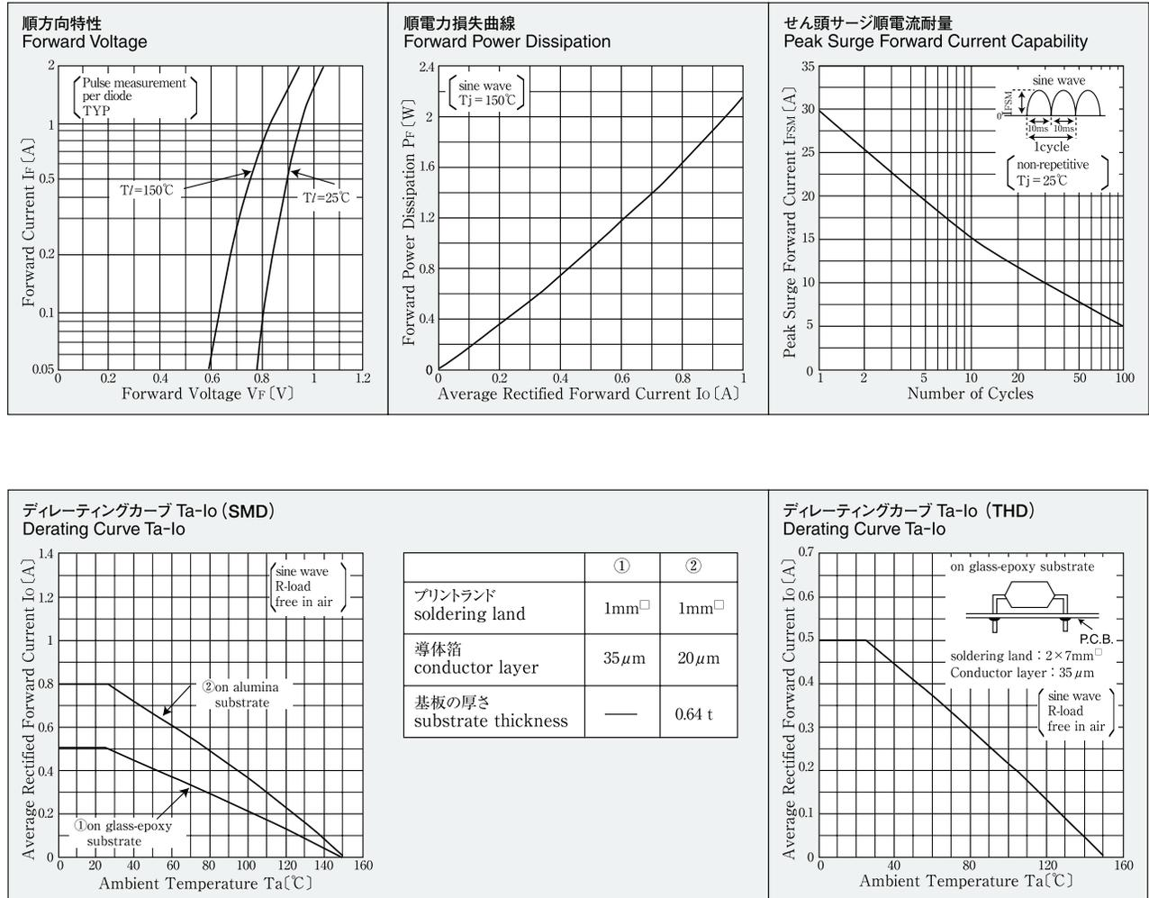
\* Sine wave は 50Hz で測定しています。
