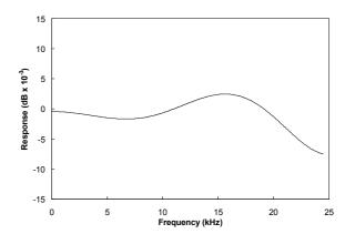
Figure 67 DSD Plus Mode Filter 4 Ripple
