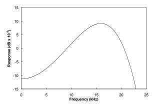
Figure 61 DSD Plus Mode Filter 1 Ripple
