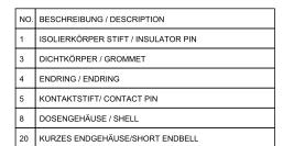
Note: Due to an automatic nomenclature system, numbers generated may not be sequential. Notiz: Durch ein automatisches Benennungssystem können Nummerierungen entstehen, die nicht fortlaufend sind Material Specification: Shell Material: Aluminium alloy
