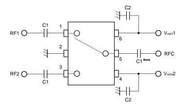
Note C1 : 0.5 to 2.0 GHz 56 pF : 2.0 to 6.0 GHz 8 pF C2 : 1 000 pF
