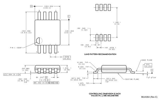
8-Lead Mini SOIC package (MM) NS Package Number MUA08A
