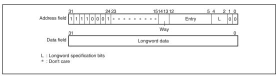
Figure 8.6 Memory-Mapped IC Data Array (Cache size = 32 Kbytes)
