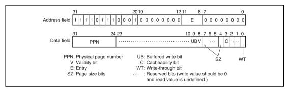
Figure 7.29 Memory-Mapped PMB Data Array
