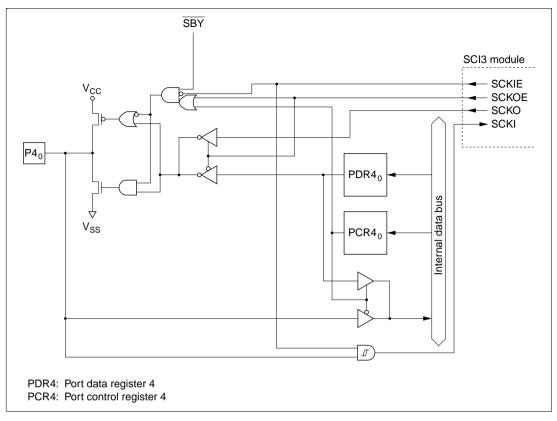
Figure C.4 (d) Port 4 Block Diagram (Pin P4<sub>0</sub>)
