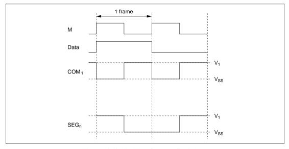
Figure 13.13 (d) Waveforms at Static Duty
