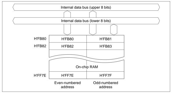
Figure 7.1 RAM Block Diagram (H8/3834)
