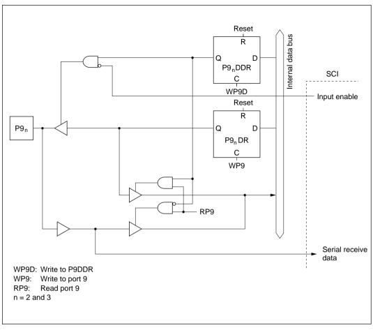
Figure C-6 (b) Port 9 Block Diagram (Pins P92, P93)
