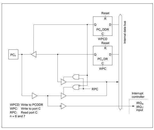
Figure C-9 (d) Port C Block Diagram (Pins  $PC_6$ ,  $PC_7$ )
