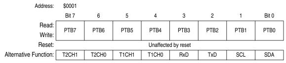
Figure 16-6. Port B Data Register (PTB)
