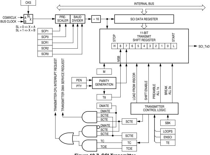
Figure 12-7. SCI Transmitter
