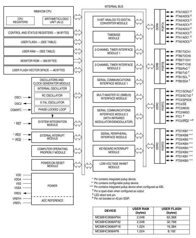
Figure 1-1. MC68HC908AP64 Block Diagram
