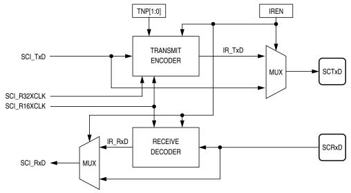
Figure 12-3. Infrared Sub-Module Diagram
