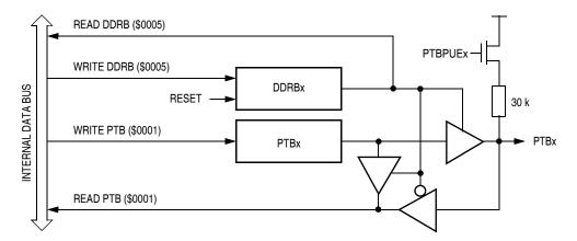
Figure 12-7. Port B I/O Circuit
