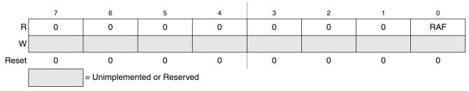
Figure 11-9. SCI Status Register 2 (SCIxS2)
