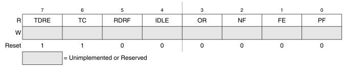
Figure 11-8. SCI Status Register 1 (SCIxS1)
