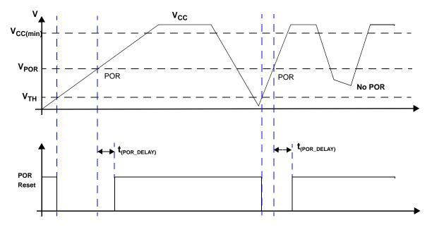
Figure 7. Power-On Reset Timing
