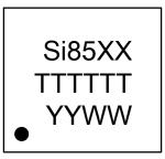
Figure 24. QFN Top Marking
