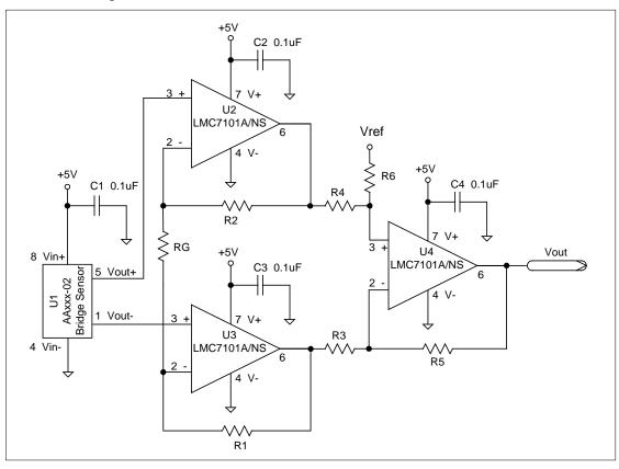
THREE OP AMP PREAMPLIFIER CIRCUIT
