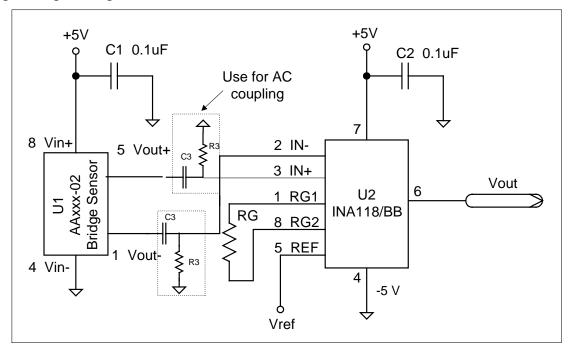
INSTRUMENTATION AMPLIFIER PREAMPLIFIER CIRCUIT
