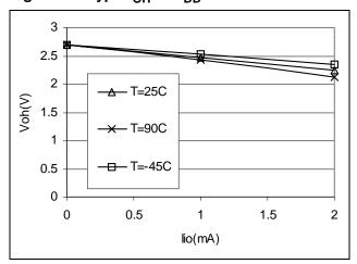
Figure 86. Typ. V<sub>OH</sub> at V<sub>DD</sub>=3V
