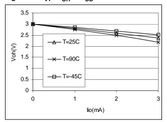
Figure 85. Typ. V<sub>OH</sub> at V<sub>DD</sub>=4V
