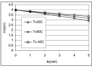
Figure 87. Typ. V<sub>OH</sub> at V<sub>DD</sub>=5V
