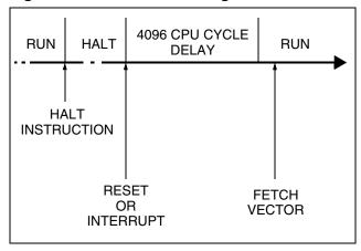
Figure 26. HALT Mode Flowchart
