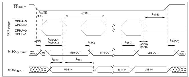
Figure 95. SPI Master Timing Diagram 1)
