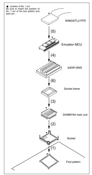
Figure 2 Usage of M3T-64DIP-DMS
