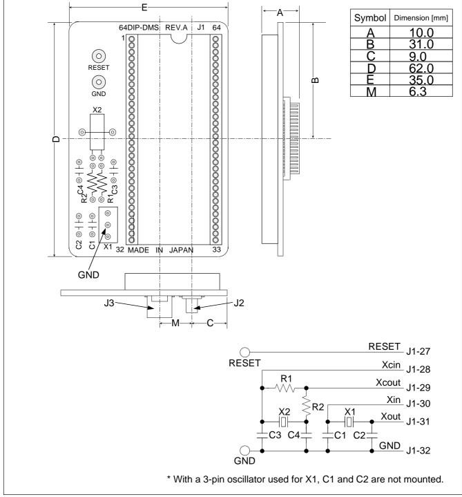
Figure 3 External dimensions of M3T-64DIP-DMS
