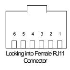
Figure 5. <u>i</u>Button SOCKET FOR DS9490B
