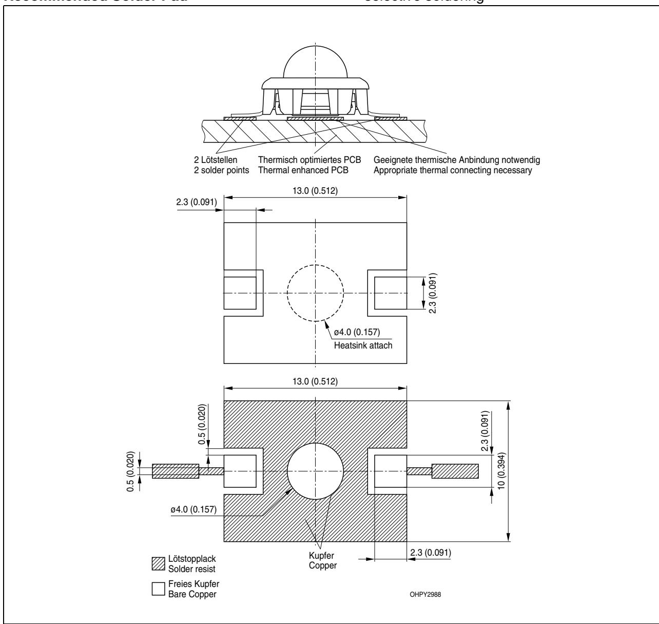
Anm.: Das Gehäuse ist für Ultraschallreinigung nicht geeignet. Für weitere Informationen bezüglich Löten verwenden Sie bitte die Applikationsschrift "Mounting Guideline for Golden Dragon with Lens"
