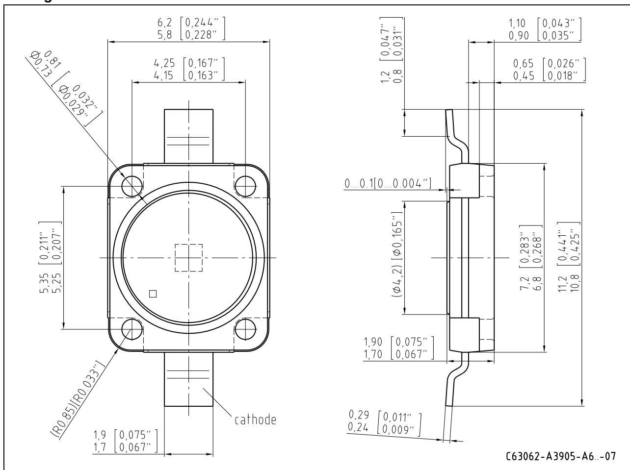
Anm.: Die LED enthält ein ESD-Bauteil, das parallel zum Chip geschalten ist.
