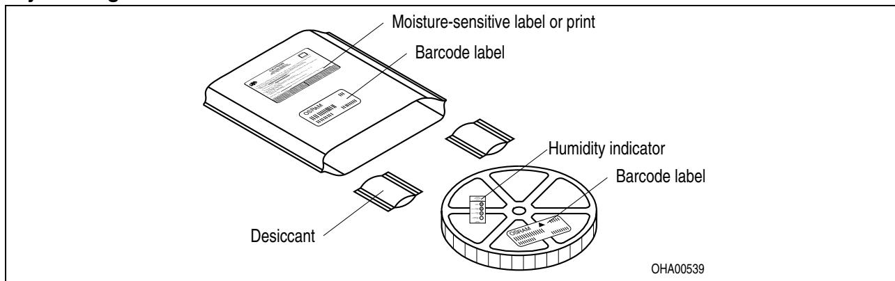
Anm.: Feuchteempfindliche Produkte sind verpackt in einem Trockenbeutel zusammen mit einem Trockenmittel und einer Feuchteindikatorkarte
