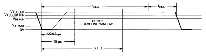
$$60~\mu s \le t_{SLOT} < 120~\mu s$$
