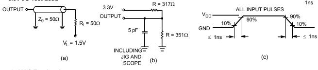
2.5V I/O Test Load
