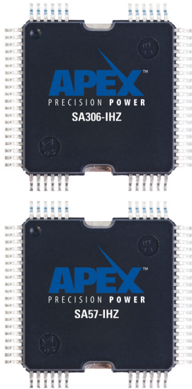
64-PIN QFP, PACKAGE STYLE HQ JEDEC MO-188
