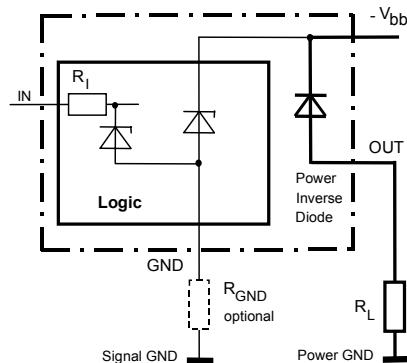
$R_{GND}=150\Omega$ ,  $R_I=3k\Omega$  typ.,
