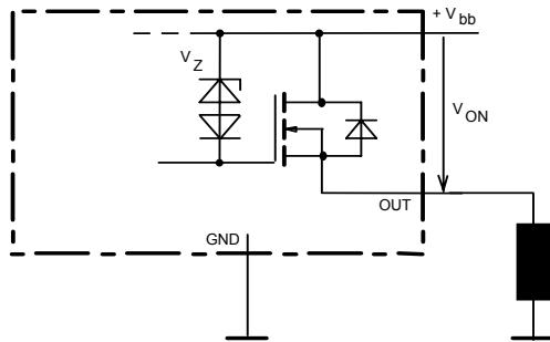
$V_{ON}$  clamped to 47 V min.
