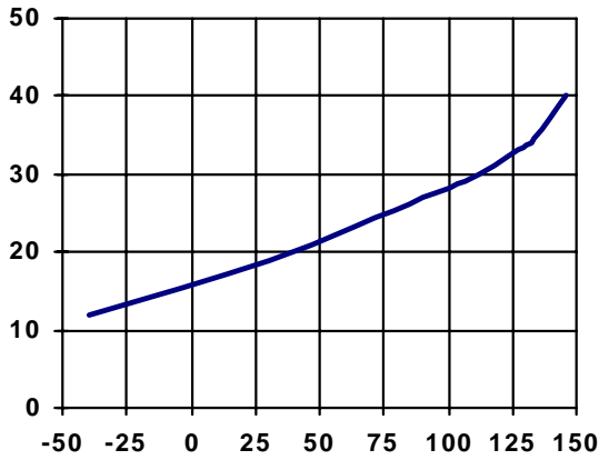
Figure 7 - Iccoff (µA) vs Tj (°C)
