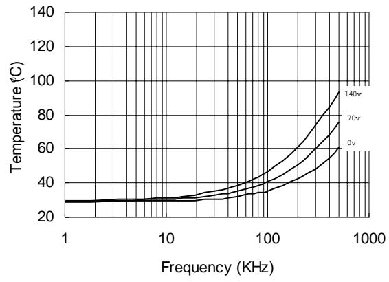
Figure 24. IR2183 vs. Frequency (IRFBC40),
