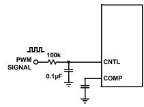
FIGURE 20. PWM BRIGHTNESS CONTROL
