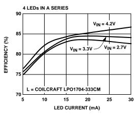
FIGURE 7B. EFFICIENCY vs IO
