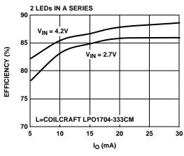
FIGURE 5B. EFFICIENCY vs IO
