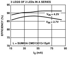
FIGURE 11B. EFFICIENCY vs IO
