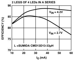
FIGURE 10B. EFFICIENCY vs IO
