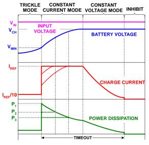
FIGURE 1. TYPICAL CHARGE CURVES USING A CONSTANT-VOLTAGE ADAPTER
