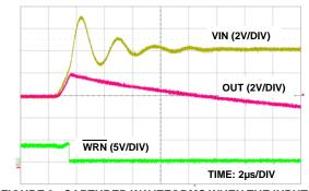
FIGURE 3. CAPTURED WAVEFORMS WHEN THE INPUT VOLTAGE STEPS FROM 6.5V TO 10.5V
