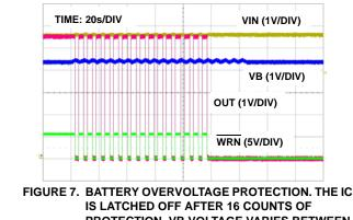
PROTECTION. VB VOLTAGE VARIES BETWEEN 4.3V TO 4.5V
