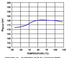
FIGURE 18. BATTERY OVP BLANKING TIME
