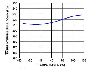
FIGURE 21. EN PIN INTERNAL PULL-DOWN RESISTANCE
